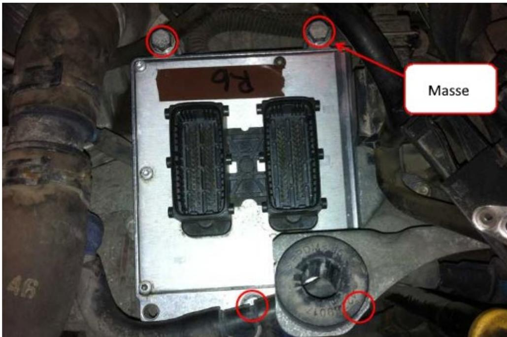
Setzen Sie nun das neue Steuergerät in umgekehrter Reihenfolge ein.
